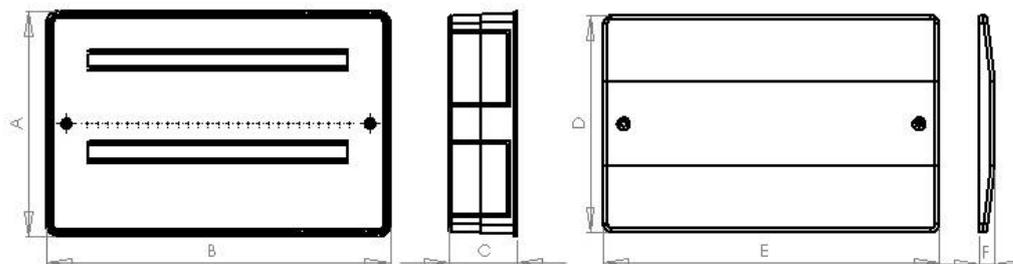
**Accessori** La cassetta in plastica include al suo interno tutti gli inserti e supporti necessari per una facile e sicura installazione di tutte le tipologie di collettori presenti nel catalogo Pintossi + C: collettori semplice e con valvole e collettori complanari.
